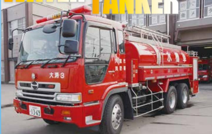
10,000ℓの水を積載し、火災現場の近くに水源がない場合に活躍する車両。大規模な災害では給水車としても活躍する。
