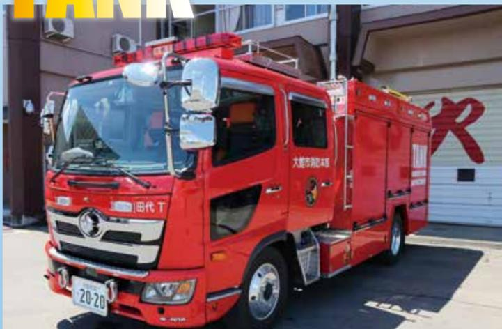
消火活動の主力となる車両。2,000ℓの水を積載しているため、火災現場の最前線で迅速な放水活動を行うことができる。
