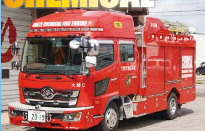
1,500ℓの水と500ℓの消火薬剤を積載し、危険物火災で活躍する。水と消火薬剤を混ぜ水を泡状にして消火する。
