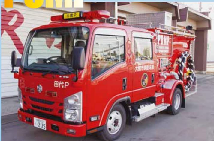
消火栓、防火水槽、池などの水をくみ上げ、消火活動を行う。1分間に2,000ℓの放水ができる。
