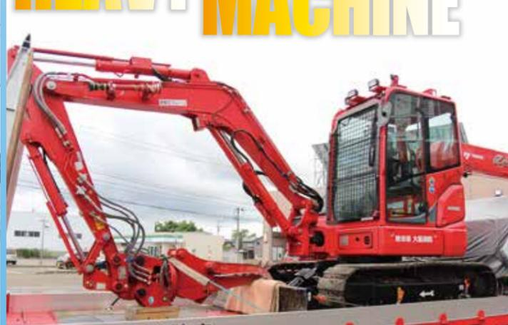
秋田県内に1台配備された緊急援助隊の車両。アタッチメントを変え、瓦礫等の掘削・把持・切断・除去を行い、迅速に救助する。
