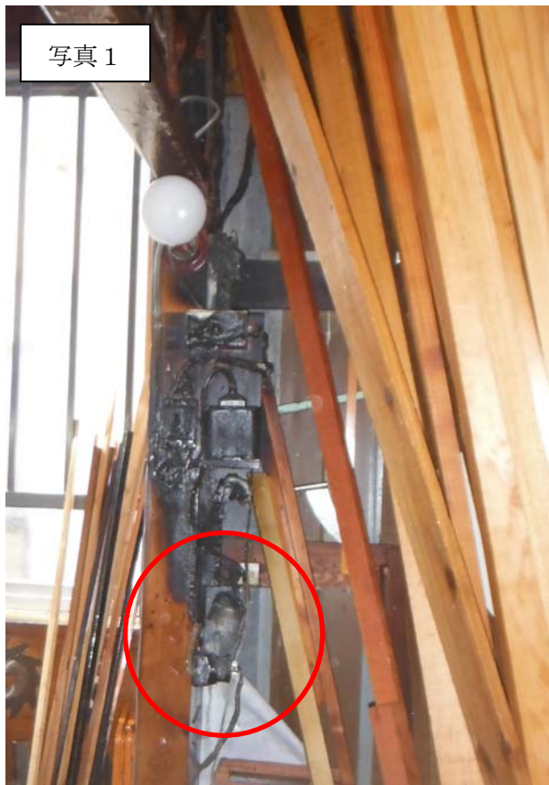
低圧進相コンデンサ火災の状況。 コンデンサを○で示す。
